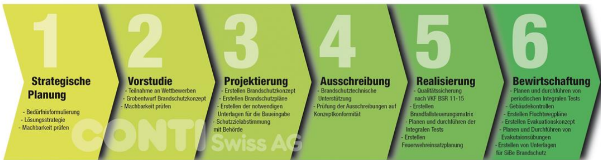
Abbildung 7: Phasen der Bauplanung nach SIA
