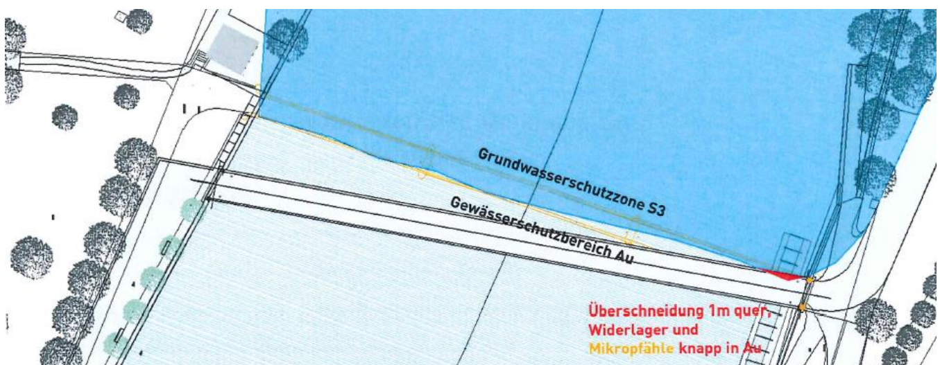
Abbildung 7: Übersicht Schnittstelle Grundwasserschutzzone S3 zum Bauprojekt Spinnereibrücke
